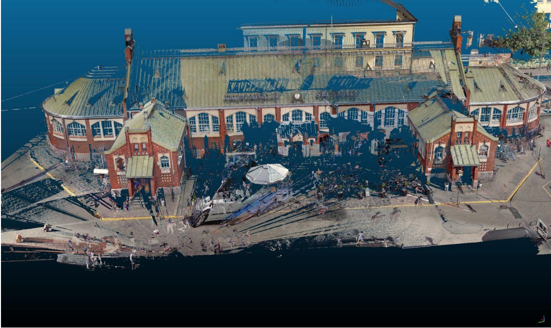
Kuva 13. LiDAR-pistepilvi. Kuvassa on havaittavissa mm. ohi kulkeneiden ihmisten/ajoneuvojen aiheuttamia aukkoja. Maa on tallentunut huomattavasti paremmin kuin vastaavassa PhotoScan-versiossa.
