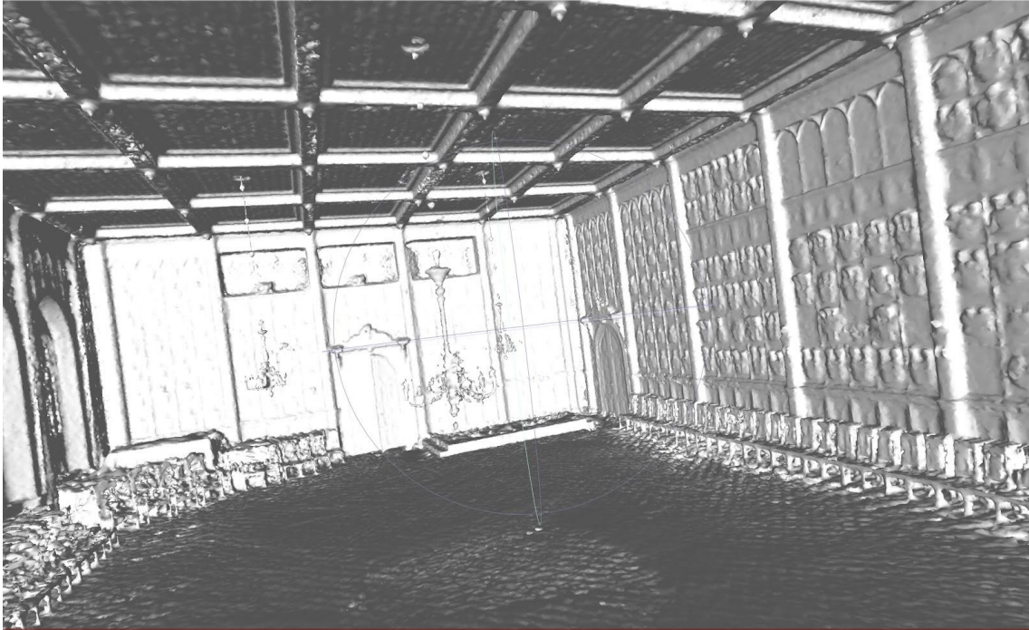
Kuva 12. Kuvassa Photoscan-pistepilvestä Faron kanssa samoilla parametreilla tehty mesh. Pinnat ovat paljon epätasaisempia johtuen mm. kuvissa olevasta pienestä kohinasta ja kontrastieroista sekä siitä miten PhotoScan on tulkinut parketissa olevan tummemman kuvioinnin hieman eri syvyydelle vaaleammasta.
